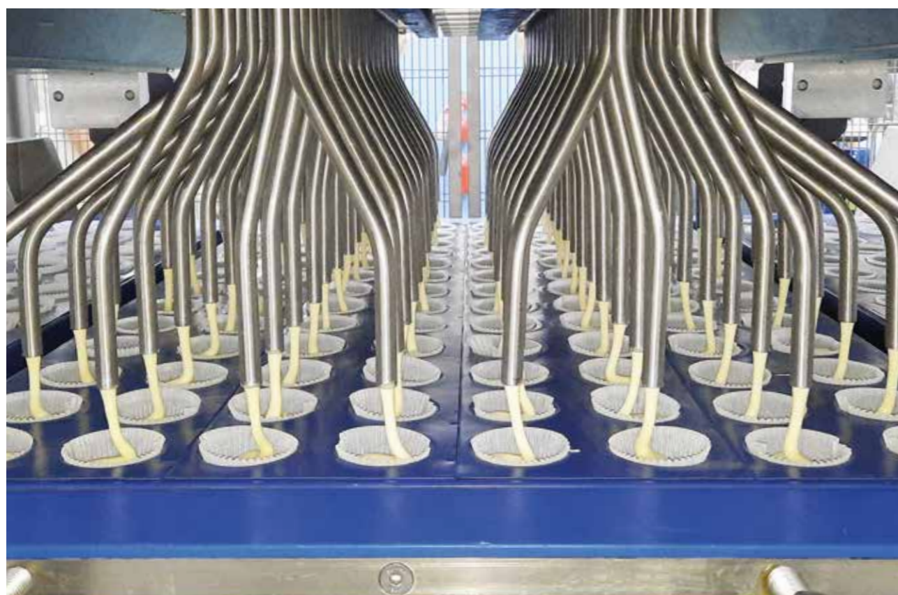
Dosaggio pasta con dosatrice DSG
